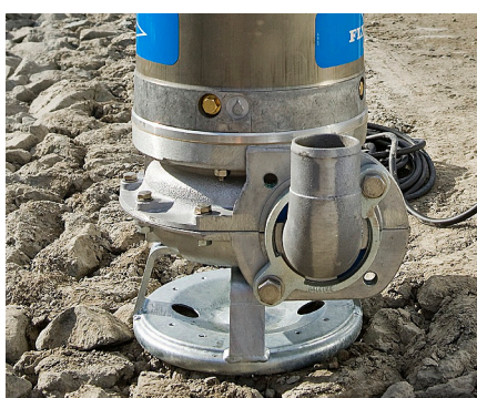
Более крупное впускное отверстие, улитка и боковая линия нагнетания Перекачивает твердые частицы диаметром до 80 мм (3,2 дюйм) и концентрацией около 20% по весу.
